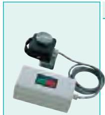
SRT064 BTH - TX Misuratore di sforzo al pedale Blue-Tooth. Consente di rilevare l'andamento dello sforzo sul pedale del freno durante tutta l'esecuzione della prova. Pedal pressure tester with Blue-Tooth transmission. For determining the pressure pattern on the brake pedal during tests Pedalkraftmesser mit Blue-Tooth-Übertragung erfasst den Kraftverlauf auf den Bremspedal während des gesamten Prüfablaufs. Mesureur de force à la pédale avec transmission par Blue-Tooth. Permet de mesurer l'évolution de la force exercée sur la pédale du frein pendant toute la durée de l'essai. Medidor de presión de pedal con Blue-Tooth transmisión. Determina la distribución de la presión del pedal de frenado durante la prueba.
