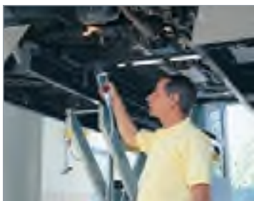
Comandi azionamento piastre su torcia con cavo di 5500mm. Standard play detector controls on torch with 5500mm cable.
