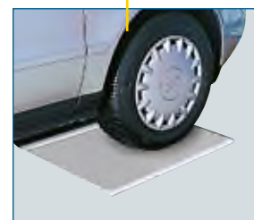
Controllo deriva Side-slip test Spurtest Contrôle de l'alignement Control de deriva
