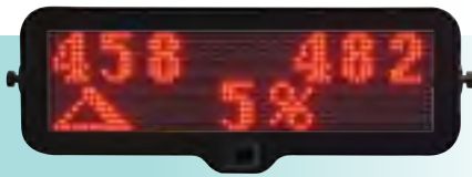
Risultati prova (forze frenanti e sbilanciamento) Test results (brake forces and imbalance) Testergebnisse (Bremskraft und Differenz)
