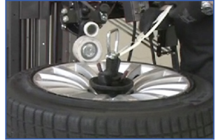
Inserimento protezione cerchio Introduction of rim protection
