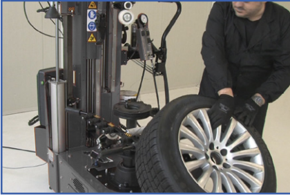
Sollevamento ruota Wheel lifting
