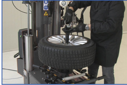
Bloccaggio ruota Wheel locking
