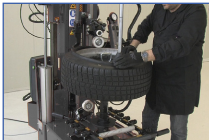
Posizionamento tallone Placement of the second bead
