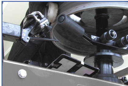
Smontaggio pneumatico Tyre demounting
