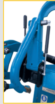
G108A40 Bloccaggio albero Shaft position lock
