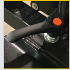
G108A40 Bloccaggio albero Shaft position lock
